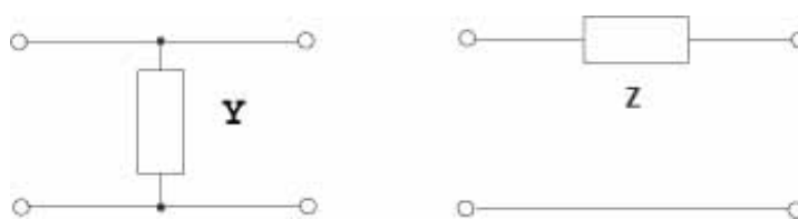
Abb. 9 Schaltskizze der beiden Basis-Vierpole
