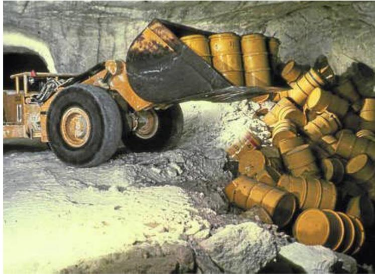
Abb. 32 Lagerung von Stahlfässern mit radioaktiven Abfällen in das Salzbergwerk Asse II (Wolfenbüttel/Niedersachsen)
