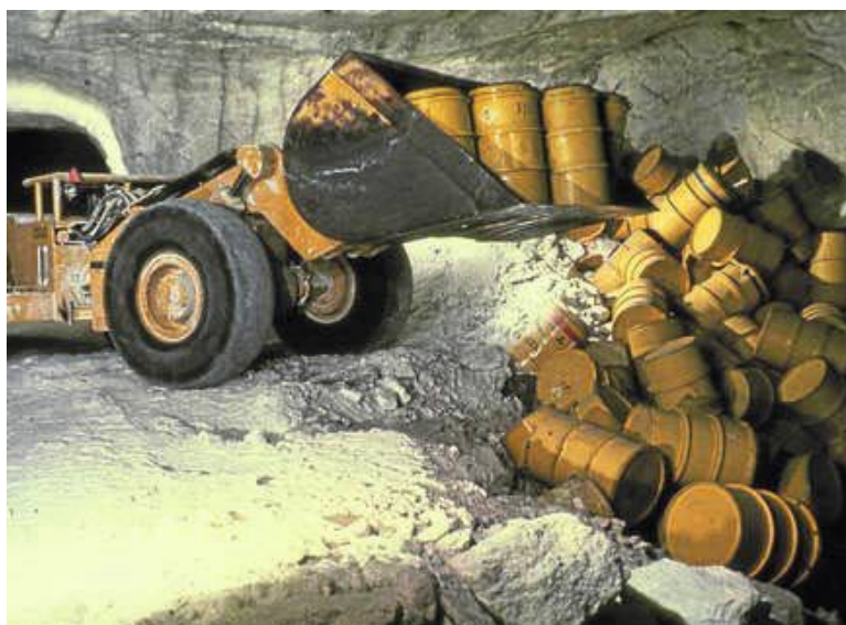
Abb. 33 Lagerung von Stahlfässern mit radioaktiven Abfällen in das Salzbergwerk Asse II (Wolfenbüttel/Niedersachsen)
