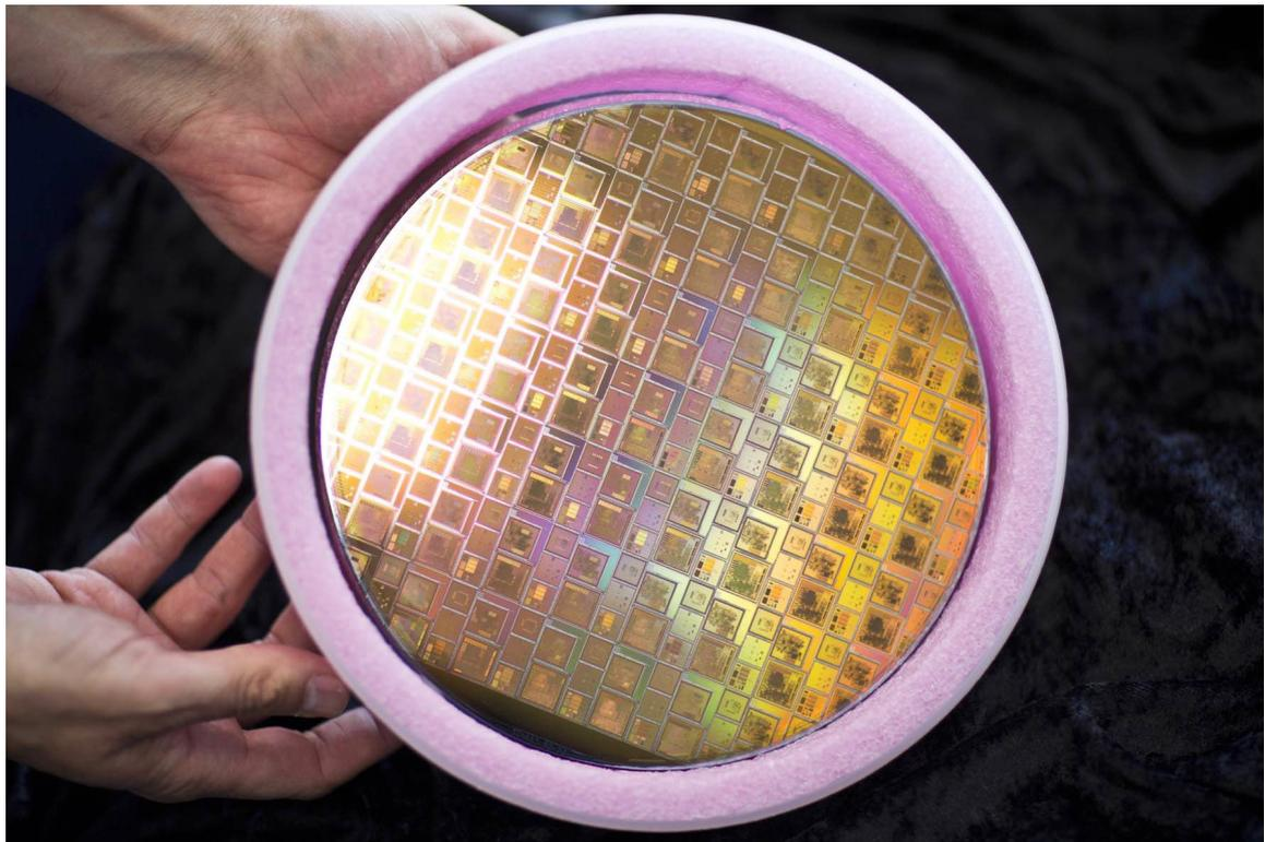
Abb. 27 20-cm-Si-Wafer mit eingezätzten 175 IC-Chips; Eigenproduktion der ESA
