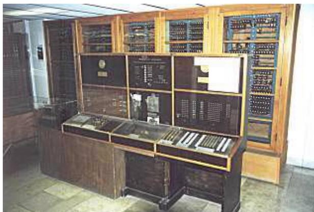
Abb. 30 Ansicht des in der Relais-Technik aufgebauten Digitalrechners Z4
