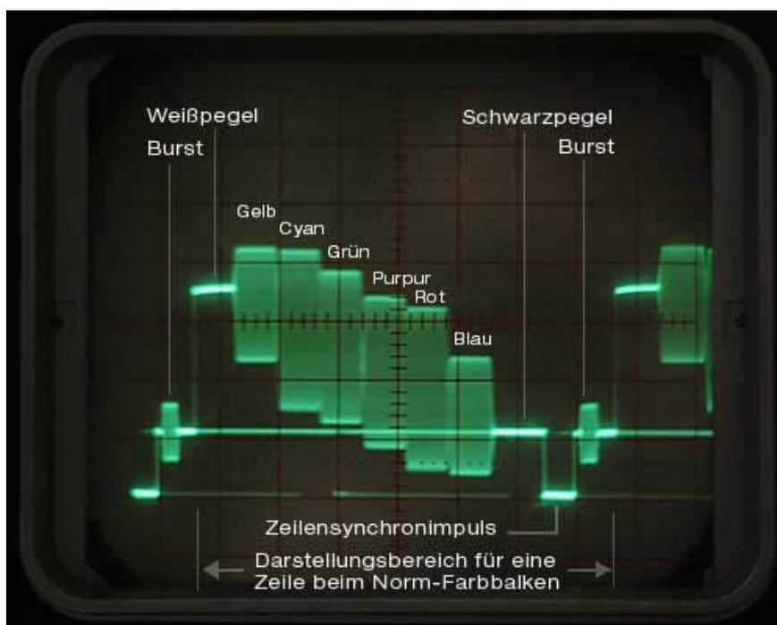
Abb. 78 Gut 1 Zeile langer Ausschnitt aus dem FBAS-Signal eines TV-Testbildes
