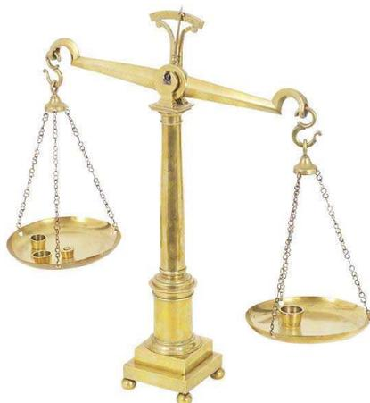
Abb. 1 Die Balkenwaage als typisches Beispiel eines vergleichenden Messinstrumentes (Quelle: [www.trempel.de](http://www.trempel.de))
