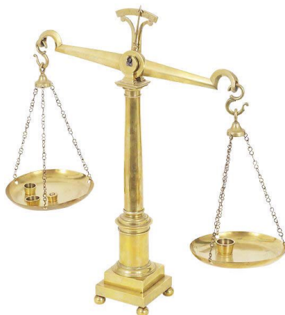
Abb. 1 Die Balkenwaage als typisches Beispiel eines vergleichenden Messinstrumentes (Quelle: www.trempel.de )
