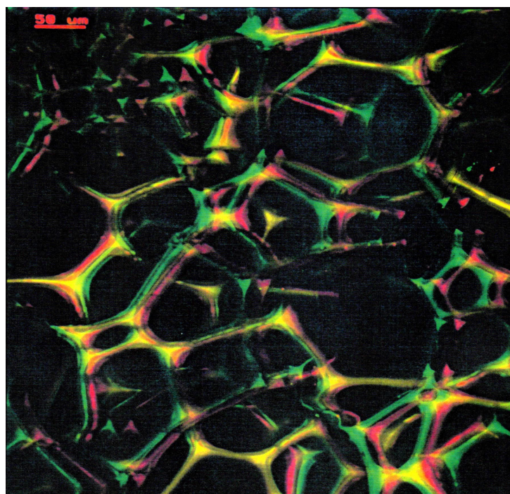
Abb. 35 3D-Porenstruktur eines Polyurethan-Hartschaums (rot/grün-kodiertes Stereobild) (Quelle: 1995 vom Autor erstellte Aufnahme)
