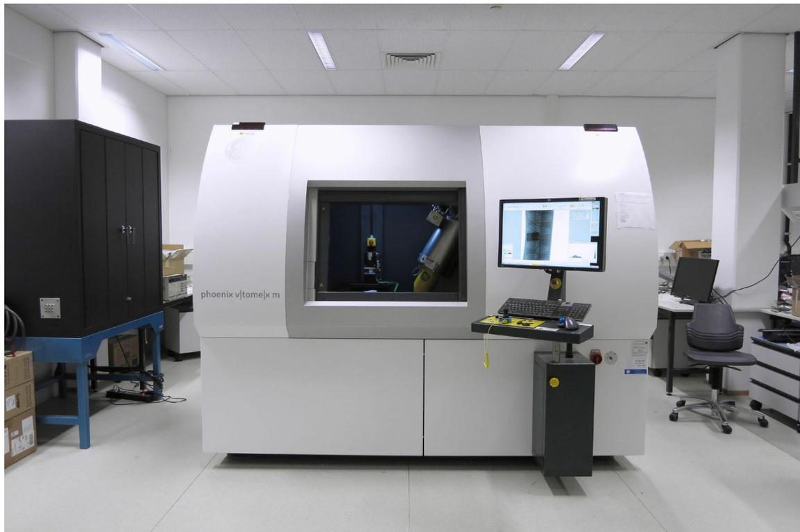
Abb. 40 Röntgenstrahl-Tomograph der ESA zur Materialuntersuchung
